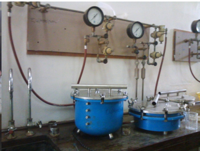
l) Pressure membrane apparatus
